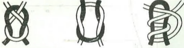
Şekil 1 Kösteklerin ana ipe bağlanışı (Nju - kaerumata)
