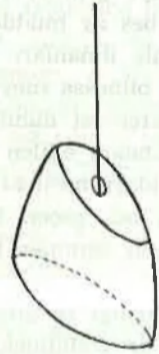
Şekil 6 Yakalanan balığın dönmeden gemiye alınmasını temin eden kurşun başlık.
